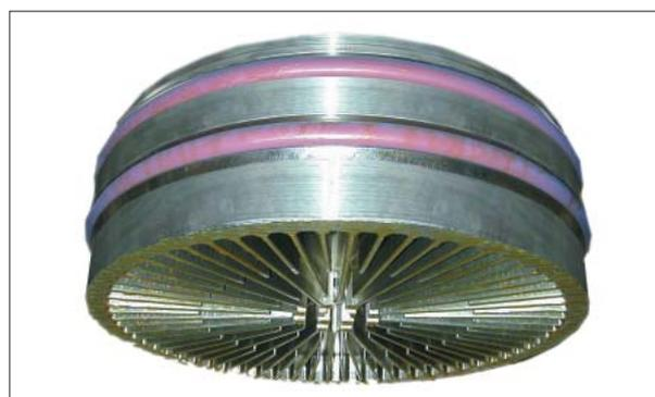
Griglia ad alta capacità di fusione
